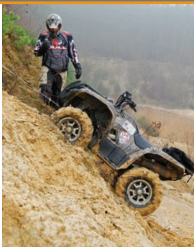
Pilotem można sterować wyciągarką stojąc z dala od quada. Teoria jednak głosi, że należy pomagać lekko gazem.
