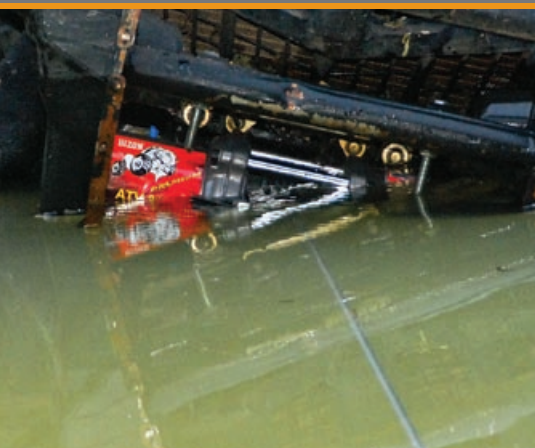
Nawet po kilkukrotnym zwinięciu pod obciążeniem liny w wodzie, wyciągarka nadal pracowała bardzo cicho.
